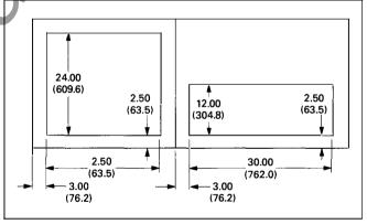
Figure 6. Conduit Space Drawing — Floor Plan
