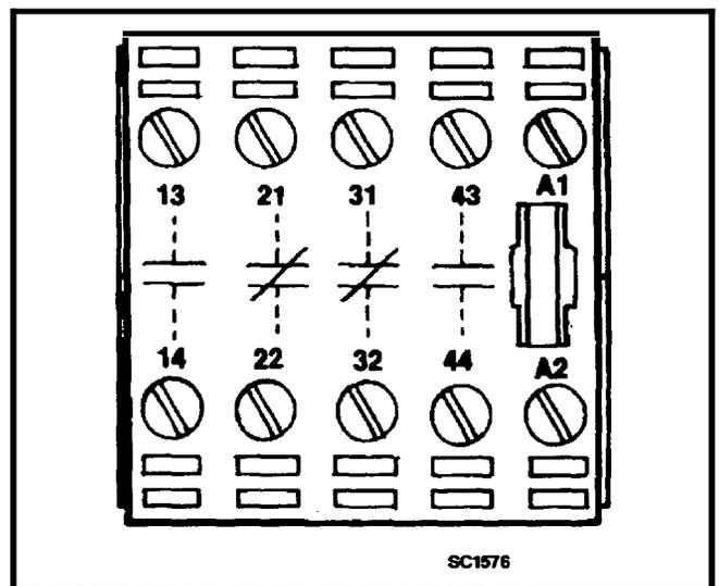
FIGURE 7-5. AUXILIARY RELAYS
