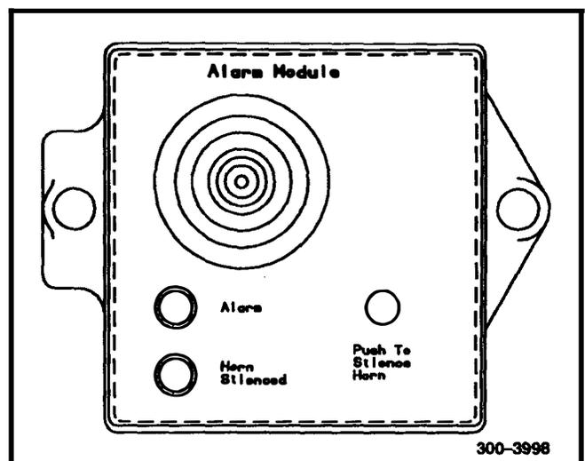
**FIGURE 6-7. ALARM MODULE**
