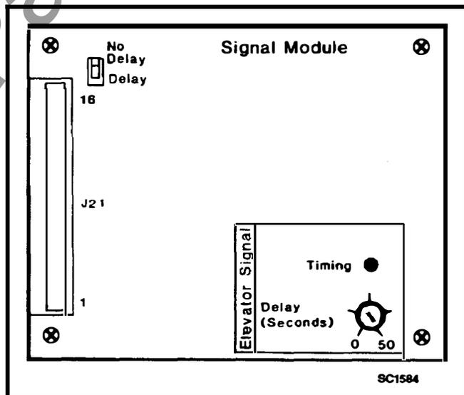
FIGURE 5-9. SIGNAL MODULE
