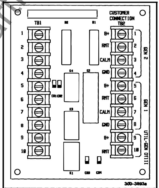
FIGURE 5-14. STANDBY SET START SEQUENCER OPTION
