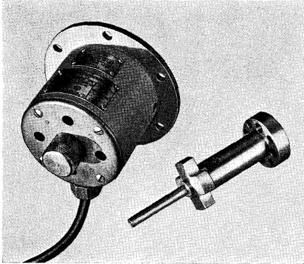
FIG. 14. Tachometer Generator
