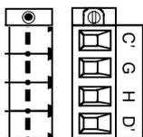
L'allacciamento per la resistenza di frenatura esterna e la precarica del modulo condensatori si trova sulla parte superiore dell'apparecchio.
